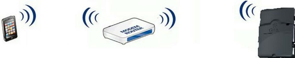
Tento režim je doporučován, protože uživateli umožňuje používat snadno větší počet SOLEM WF modulů prostřednictvím jediné Wi-Fi sítě bez nutnosti přepínat mezi bezdrátovými sítěmi jednotlivých modulů.
