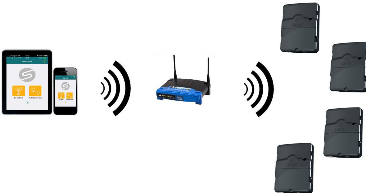
Všechny produkty SOLEM WF jsou pak z mobilního zařízení ovládány a programovány připojením na domácí router.
